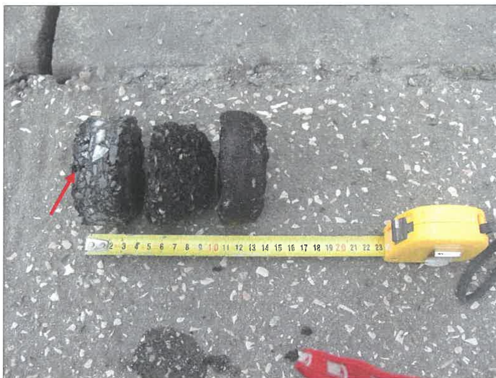
Foto 8: Zjištěná skladba souvrství vozovky v místě vrtu V8. Šipkou vyznačen líc vozovky.
