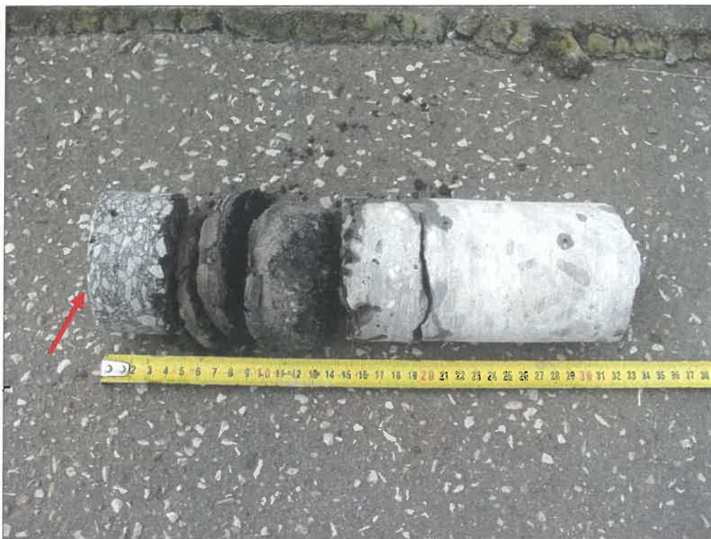
Foto 7: Zjištěná skladba souvrství vozovky v místě vrtu V7. Šipkou vyznačen líc vozovky.
