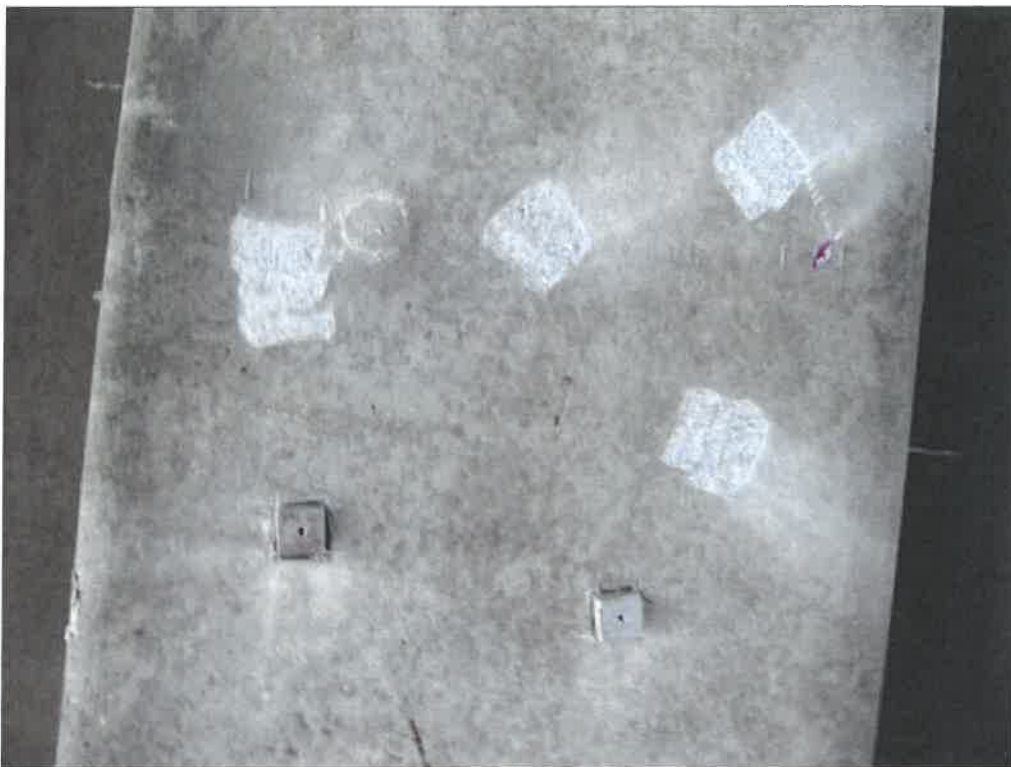
Foto 3: Pohled na zkušební místa (nedestruktivní stanovení pevnosti betonu v tlaku, odtrhové zkoušky a stanovení hl. karbonatace betonu) na spodním líci nosníku, K02.
